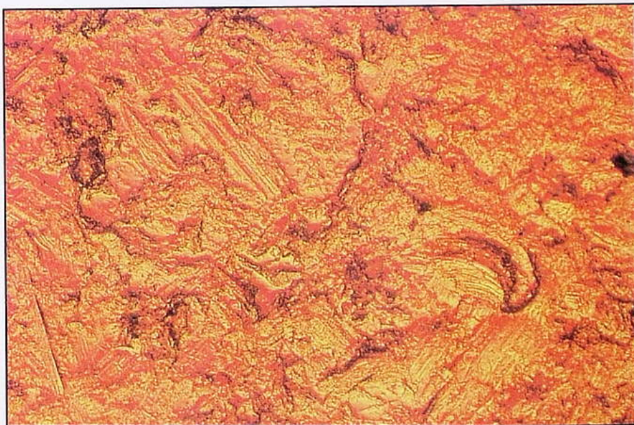
Mikroskooppikuva Lapin kultahipulle tyypillisestä pintarakenteesta. Hipun pehmeän hohteen aiheuttavat mikroskooppiset kultakiteet ja jäätikkötoiminnan synnyttämät mikrouurteet ja painaumat. Suurennos on 93-kertainen. Kuva: Kari A. Kinnunen.
